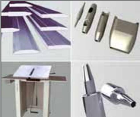
Fleje de acero para fabricar troqueles. Boquillas y punzones para los troqueles. Máquinas para fabricar troqueles. Agujas de perforar. Máquinas para calzado y marroquinería.
